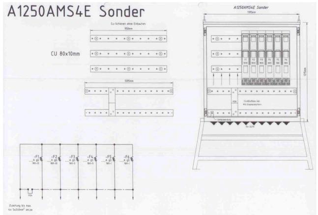
Input: 1250A Kupferschiene mit M12 Bolzen
